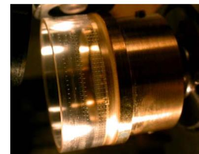
図. プリント実験に使用されたシリンダー
